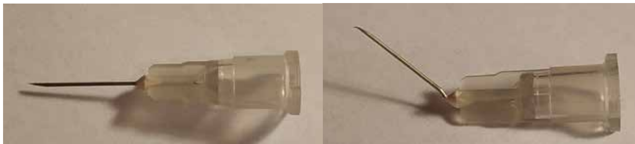
Figura 1. Aguja 27G antes (A) y luego de doblar su bisel para la creación de cistótomo (B).
